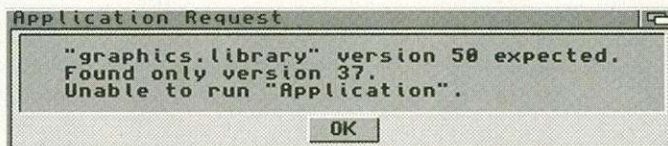
Informell: Die Klasse »LibraryBaseErrC« weist den Benutzer auf nicht vorhandene Bibliotheken hin
